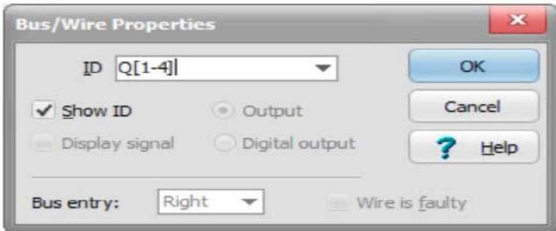
Теперь подключите шину к цепи, используя провода, начиная с узлов цепи резисторов и заканчивая шиной. Дважды кликните по соединительным проводам, установите их ID из раскрывающегося списка, и нажмите ОК.
